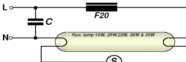
schema di collegamento ballast F20 + lampada + starter (S) + condensatore di rifasamento (C)
