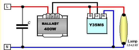
**FIG.2 schema di coll. con accenditore a sovrapposizione mod.Y150MS
