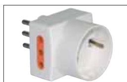
Adattatore multiplo 2P+T - Max 1500W - 250V~ - 10A - Due prese 2P+T Italiano tipo P11 - Una presa 2P+T Italiano e tedesco tipo P30 16A - Una spina 2P+T standard Italiano tipo S11 Multiple adapters 2P+T - Max 1500W - 250V~ - 10A - 2 Italian standard sockets 2P+T P11 type - 1 Italian and German socket P30 type 16A + 1 Italian plug 2P+T S11
