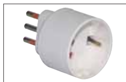
Adattatore semplice 2P+T - Max 1500W - 250V~ - 10A - una presa 2P + T standard Italiano e Tedesco tipo P30 - Una spina 10A 2P + T standard Italiano tipo S11 Simple adapters 2P+T - Max 1500W - 250V~ - 10A - One Italian and German standard socket 2P + T P30 type - One Italian standard plug 10A 2P + T S11 type
