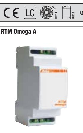
Varialuce per barra DIN. La regolazione può avvenire in due modi, o tramite potenziometro 100 kΩ (fornito), oppure con segnale 0÷10Vcc. Il comando a potenziometro può essere portato anche a grande distanza (100 metri), utilizzare canalizzazione dedicata. L'assorbimento relativo al comando 0÷10Vcc è <1 mA.
