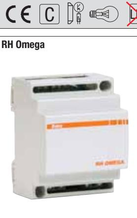
Varialuce per barra DIN. La regolazione avviene per mezzo di pulsanti NA (non a corredo). RH omega è realizzato con tecnologia IGBT, adatto quindi alla regolazione di trasformatori elettronici, è dotato inoltre di soft-start, e protezioni termica, sovraccarico e corto circuito.
