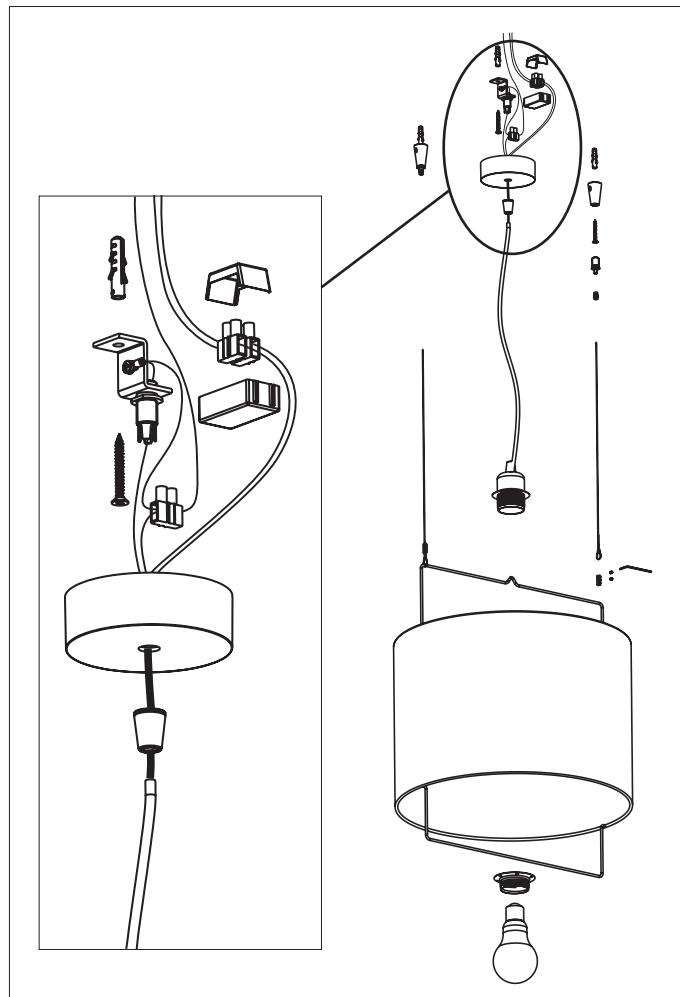
Dopo aver effettuato i fori a soffitto, fissare il cono metallico (a) mediante i tasselli in dotazione.
