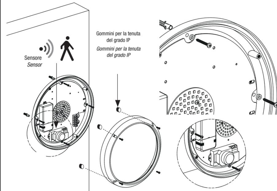
**Chiusura:** posizionare diffusore e cornice, prestando attenzione al corretto posizionamento della guarnizione, quindi serrare le 4 viti di chiusura
