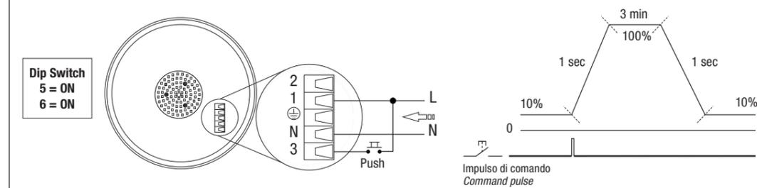
La lampada una volta alimentata risulterà sempre accesa ad un livello pari al 10% del livello nominale. Alla pressione del pulsante si ottiene l'accensione al massimo
