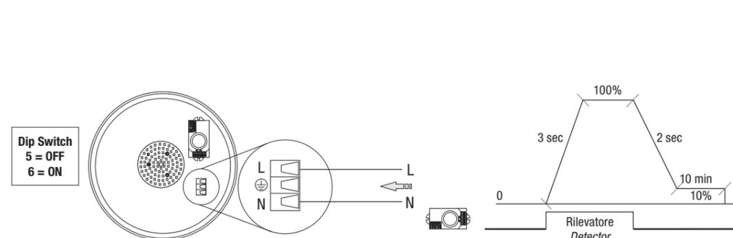
Il funzionamento della lampada, sarà gestito dal rilevatore a micro onde interno. Per l'impostazione dei tempi, sensibilità e lux di intervento, consultare il foglio istruzioni del rilevatore.
