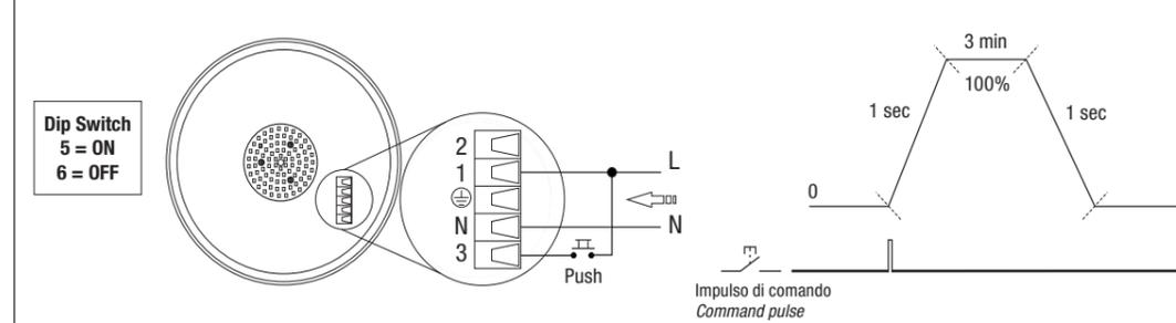
Accensione mediante pulsanti normalmente aperti (non luminosi). Una pressione prolungata > 30sec permette la funzione pulizia scale lasciando accesa la lampada per un tempo pari a 30 min.
