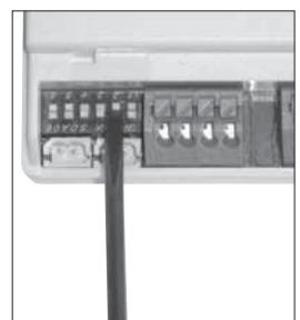
Tutti gli apparecchi LED Road sono equipaggiati di Driver multipotenza che permettono tramite la selezione del dip switch, di scegliere la tensione in uscita.
