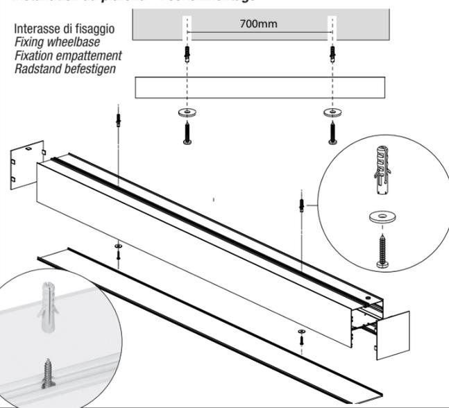
Installazione a sospensione - Suspended installation
