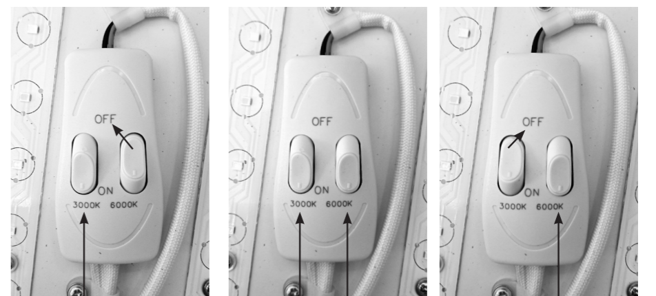
INTERRUTTORE ON / SWITCH ON INTERRUPTEUR ON / SCHALTEN ON 3000K 2 INTERRUTTORI ON / 2 SWITCHES ON 2 INTERRUPTEURS ON / ZWEI SCHALTER ON 4000K INTERRUTTORE ON / SWITCH ON INTERRUPTEUR ON / SCHALTEN ON 6000K
