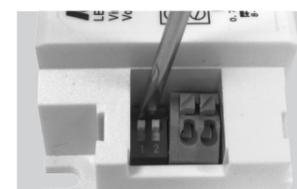
Driver fornito di dip switch per la selezione della corrente in uscita.
