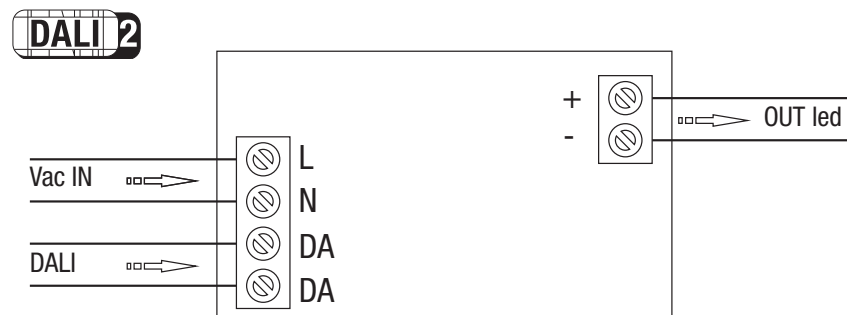
Fig. 1 - Regolazione DALI 2 - DALI 2 control
