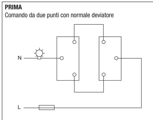
Comando diretto mediante deviatore a pressione e regolazione mediante rotazione della stessa manopola. Consente la sostituzione dei tradizionali deviatori. Impostato il livello di luminosità desiderato, premendo la manopola si spegne la sorgente, premendo nuovamente si riaccende al livello di luminosità impostata. I morsetti (nella Serie Light, International e Light Tech) contrassegnati 1, 2 e 3 come riportato negli schemi di collegamento, indicano:
