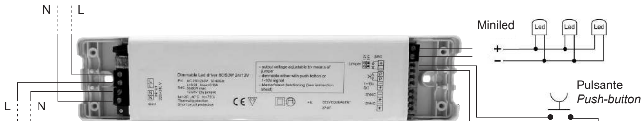
Fig. 1 - Comando con pulsante - Push-button control
