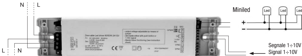
Fig. 2 - Comando con segnale 1÷10Vcc - Control with 1÷10Vcc signal
